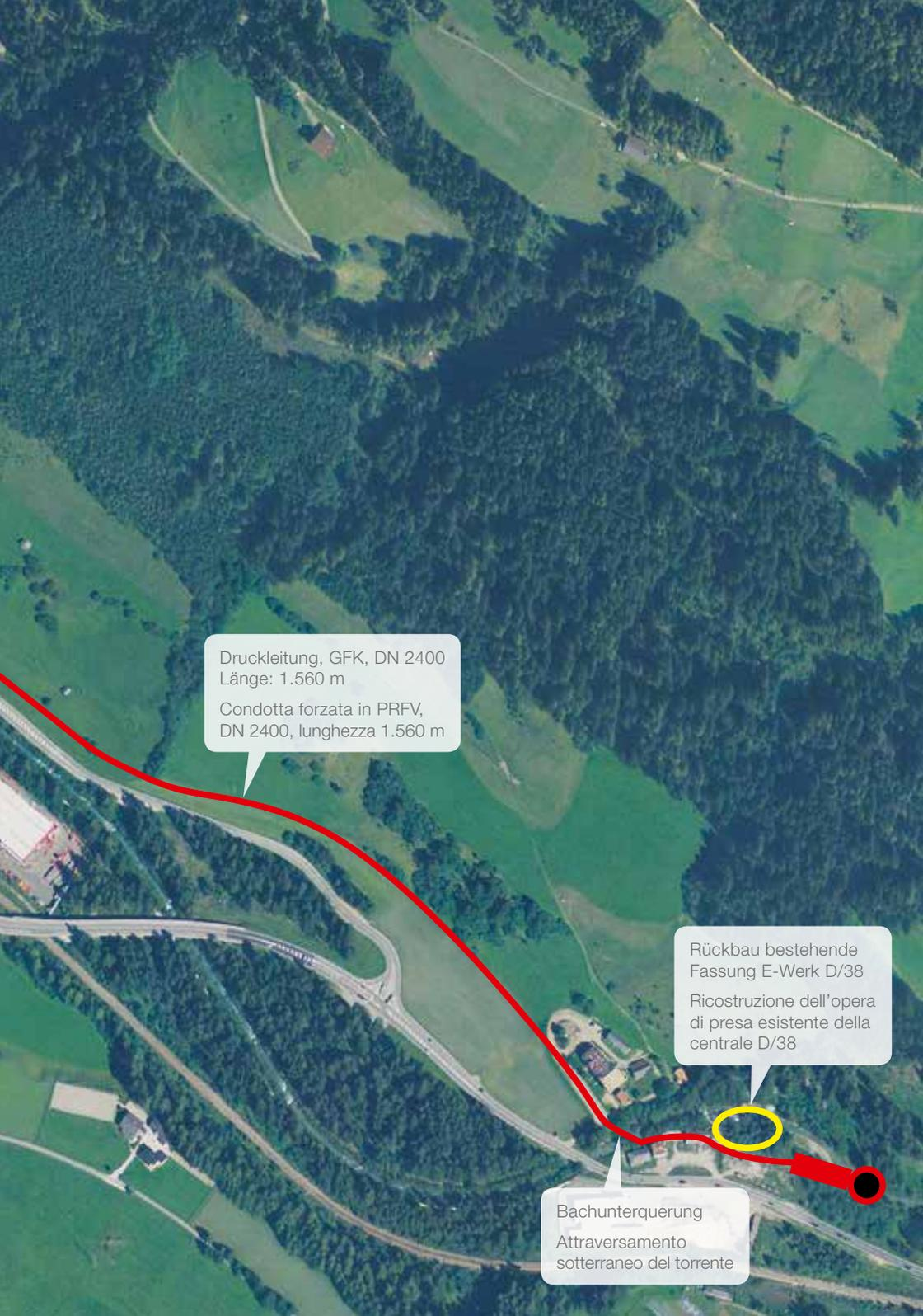
Druckleitung, GFK, DN 2400
